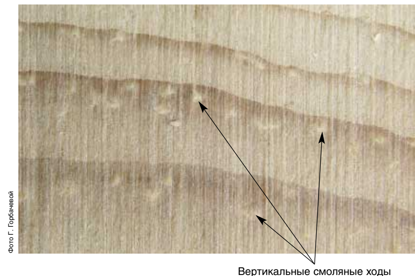
Рис. 7. Смоляные ходы в древесине кедр
