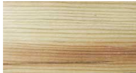
Рис. 28. Грибные ядровые пятна и полосы
