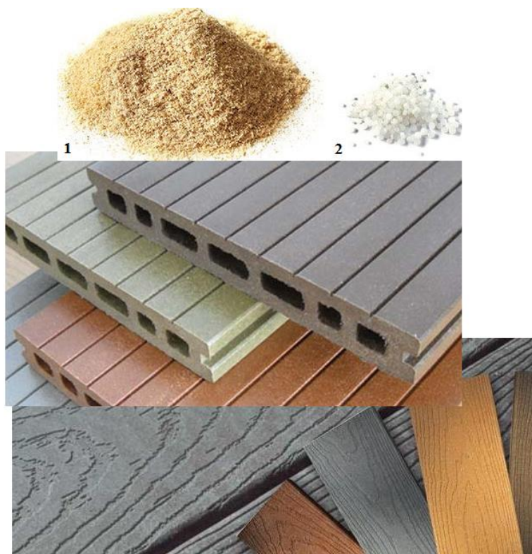
Рис. 4.41. Компоненты ТДПК (1 –измельченная древесина, 2 – полимерное связующее) и готовые изделия
