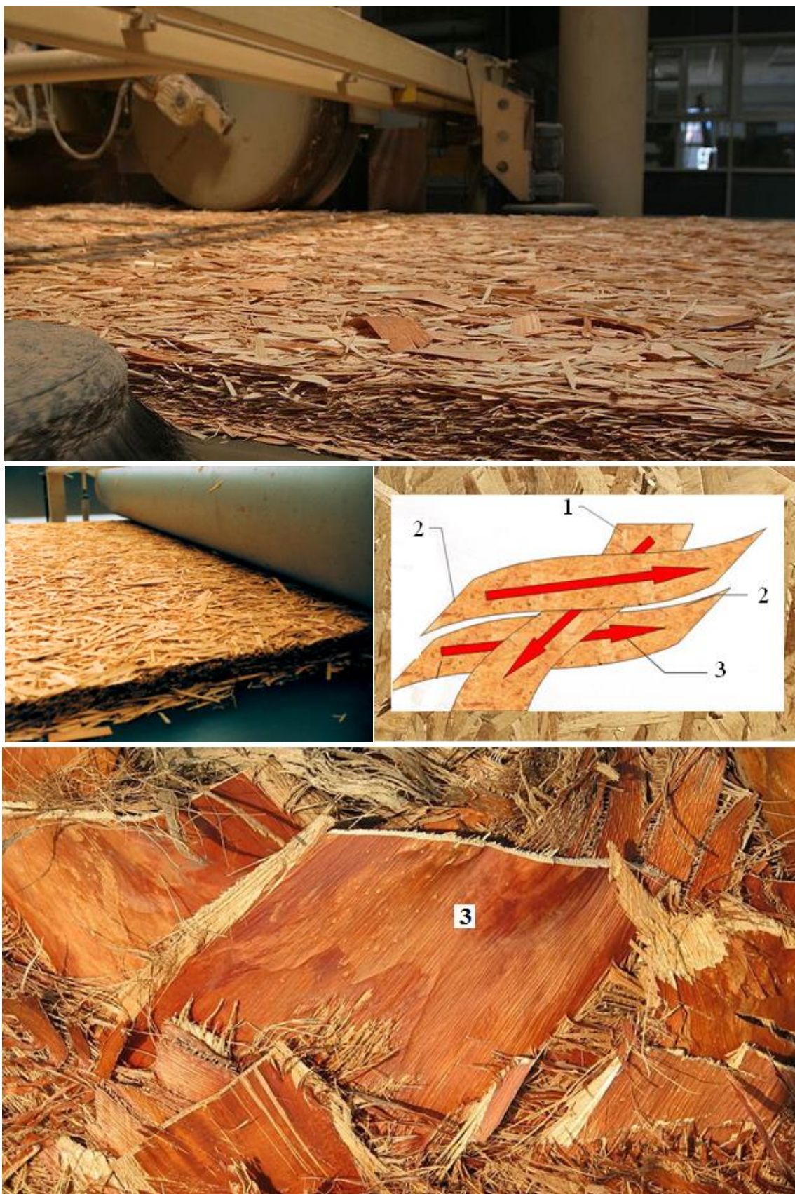
Рис. 4.37. Производство плит OSB: 1 – внутренние слои, 2 – внешние слои, 3 – стружка
