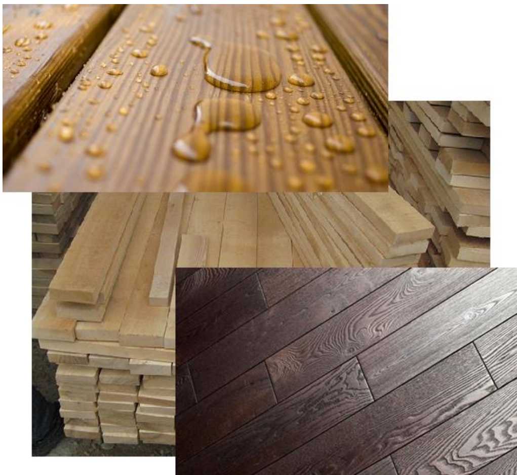
Рис. 4.40. Пиломатериалы из ясеня до и после модификации
