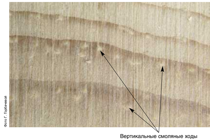
Рис. 7. Смоляные ходы в древесине кедра
