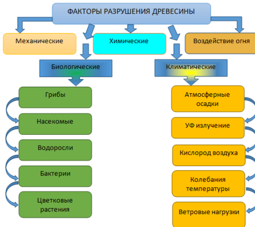
Рис. 3.21. Факторы разрушения древесины
