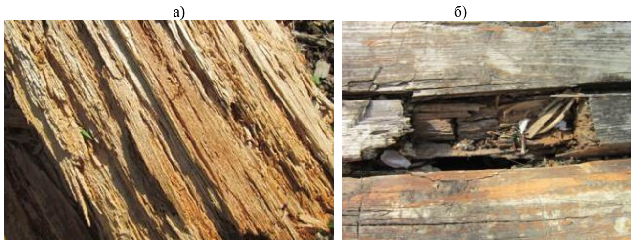
Рис. 3.24. Структура (а) и образец (б) гнилой древесины в конструкции
