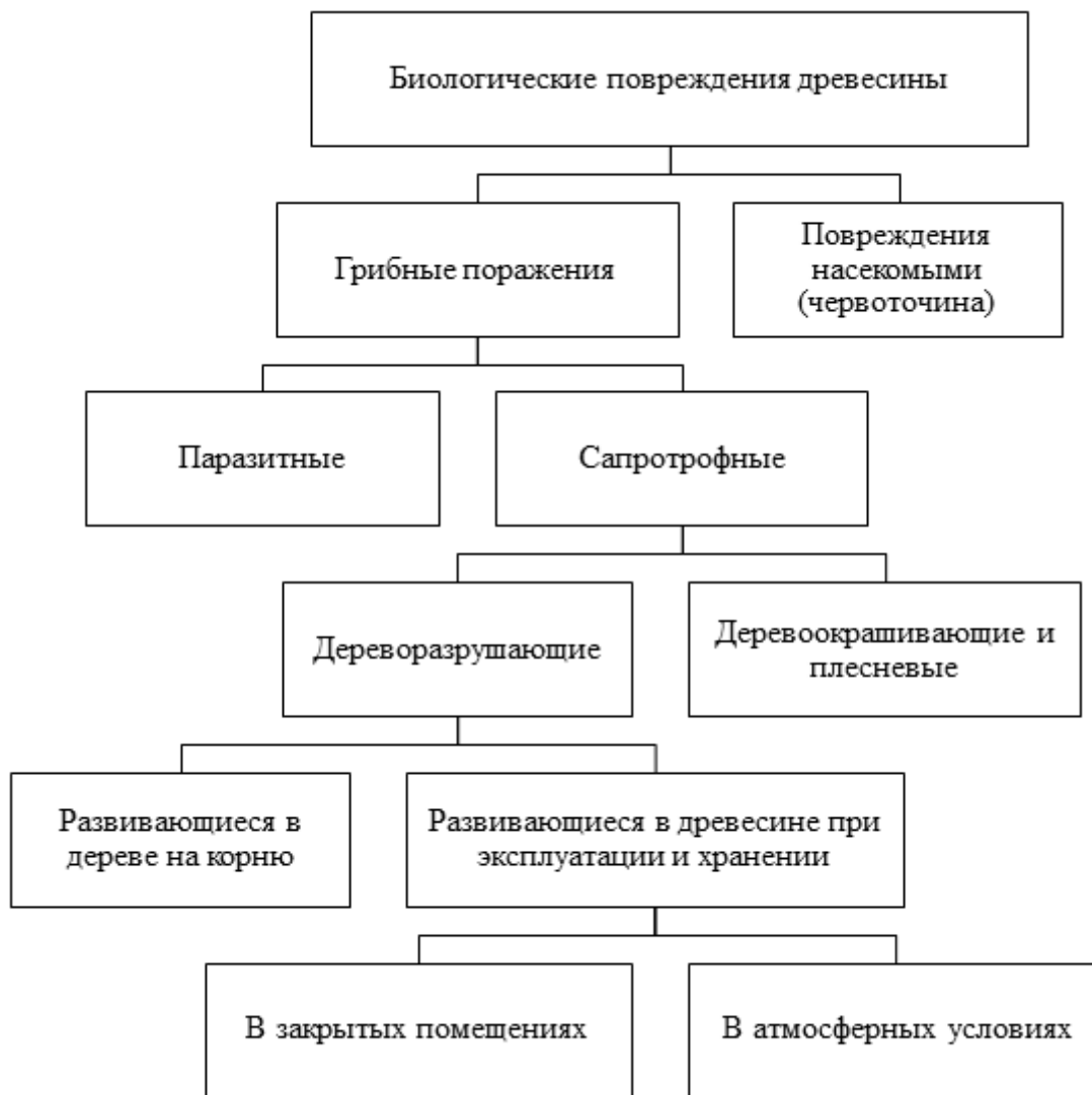
Рис. 3.19. Классификация биологических повреждений древесины
