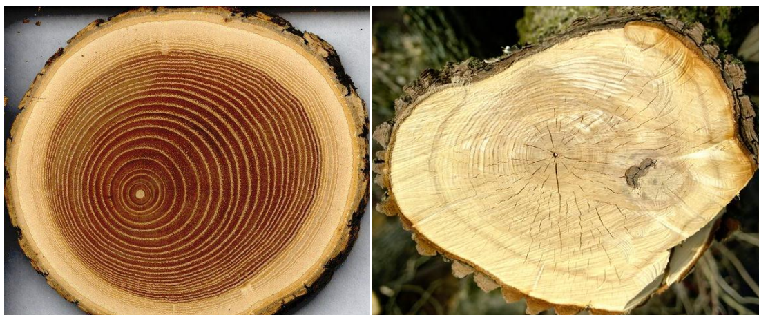
Рис. 3.7. Годовые слои древесины, произрастающей в разных климатических условиях
