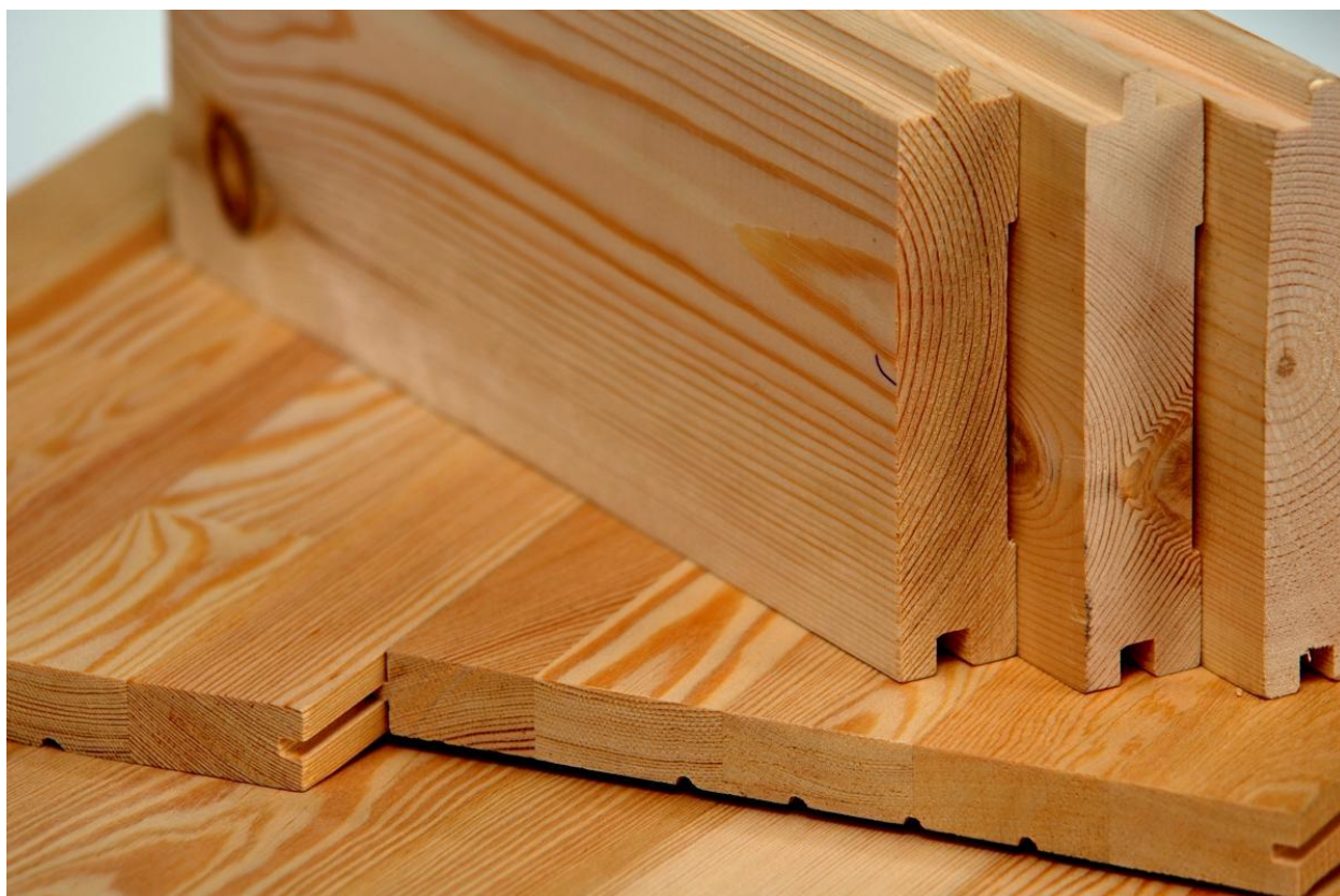
Рис. 3.10. Текстура древесины в изделиях в зависимости от разрезов ствола
